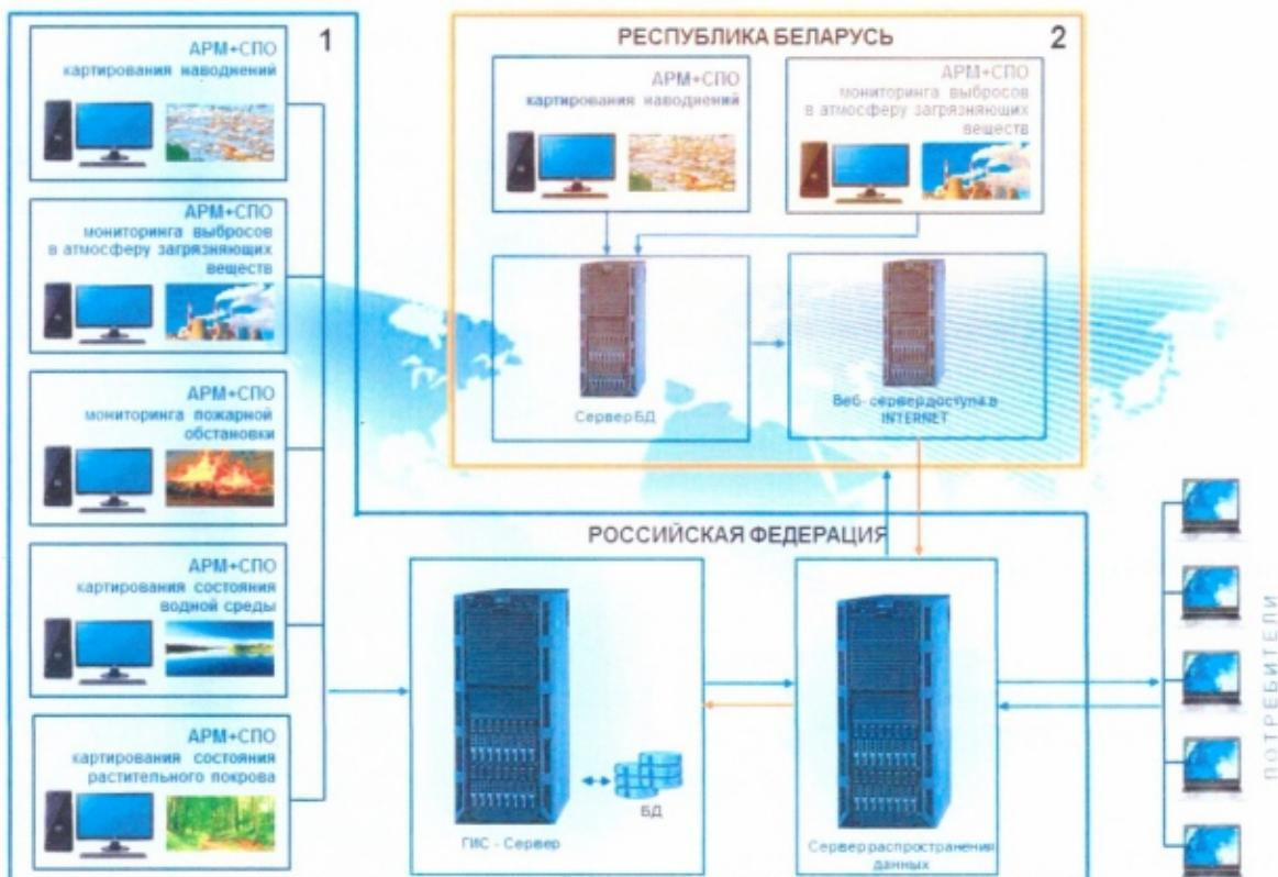
Рисунок 6 – Функциональная схема аппаратно-программного комплекса обработки спутниковых данных Российской Федерации (блок 1) и Республики Беларусь (блок 2)
